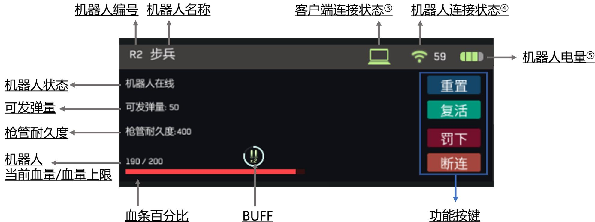
客户端连接状态<sup>③</sup>: 客户端已连接显示绿色, 未连接显示红色
